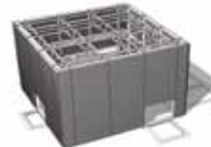
FISSAGGIO LAMELLE ALLA STRUTTURA PORTANTE
