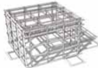
MONTAGGIO TELAI0 STRUTTURA PORTANTE DELLA PIAZZA
